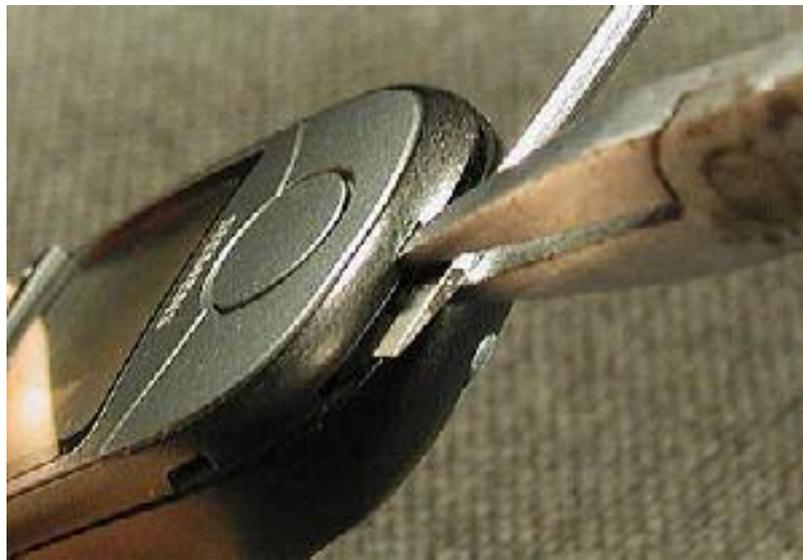
Таким образом, мы делаем самую сложную часть разборки - расцепляем верхнюю пару защелок корпуса.
