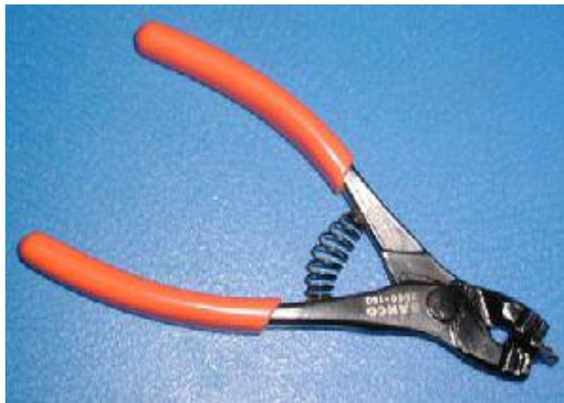
Плоские губки данного инструмента помещаются в прямоугольное углубление в верхней части корпуса телефона.
