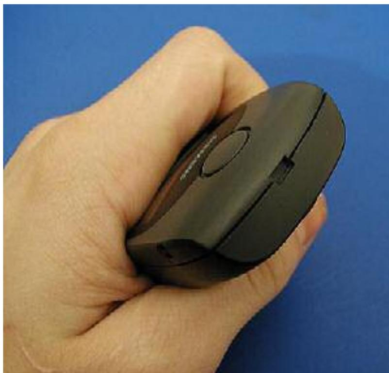
После чего, надавливая на рукоятки, вы разжимаете верхние части половинок корпуса.
